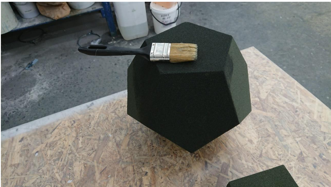
Obrázek 40: Natírání modelu epoxidem, foto: autor
