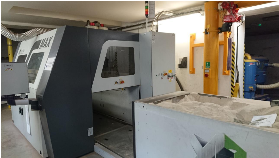
Obrázek 35: 3D tiskárna písku použitá na tisk, foto: autor
